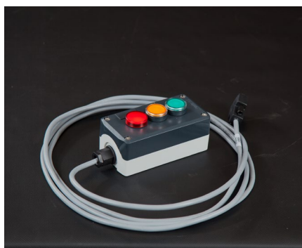
3ボタンスイッチ マーキングの開始/緊急停止
